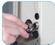
9S标配温度传感器, 可实时显示被测样品温度
